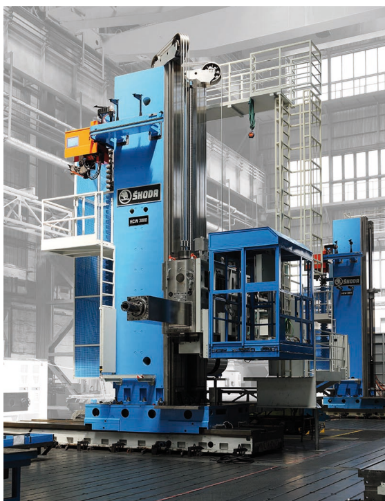
■ OBR. 6: HORIZONTÁLNÍ VYVRTÁVAČKA. STROJ TÉTO VELIKOSTI STOJÍ OKOLO 25 MIL. Kč. DOBA DODÁNÍ JE 1 ROK (ŠKODA MACHINE TOOL).
